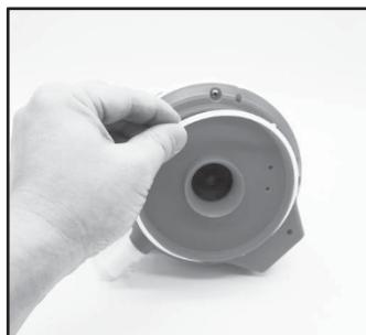
2. Usare il cacciavite per svitare le 4 viti collocate nella parte inferiore della testina per rilasciare il piatto inferiore. Usare il cacciavite per svitare tutte le viti presenti sulla base, come illustrato. Rimuovere la ventola e sollevare la base e rimuoverla per esporre la testina all'interno.
