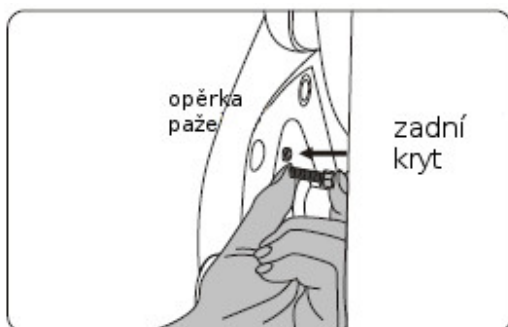
Upevnění šestihranného šroubu na zadní straně opěrky. (Obr. 9)
