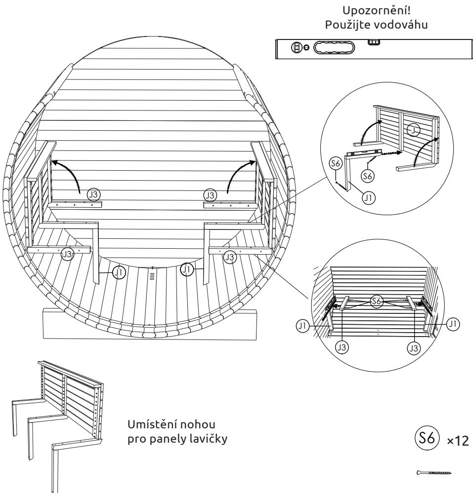
**KROK 18:** Před upevněním opěradla pomocí šroubů předvrtejte otvory a namontujte opěradla (J2) pomocí šroubu 4,0 × 70 SS (S2). Připevněte saunovou lavici (J) k nástěnným držákům a opěrné noze pomocí šroubů 5 × 70 SS (S6). Připevněte panel lavice (je-li objednán) pomocí šroubů 4,0 × 50 SS (S5).
