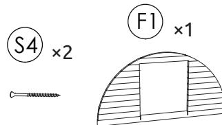
**KROK 8:** Vezměte horní zadní panel (**V3** nebo **V1**-panoramatické okno) a položte jej na spodní zadní panel (**V**). Zajistěte jej pomocí 2 šroubů 5,0 × 120 (**S4**). Spojte panely (**F2; V3**) dohromady umístěním jedné patky těla (**C**) na obě strany, kam dosáhnete, pomocí šroubů 4,0 × 60 (**S10**).
