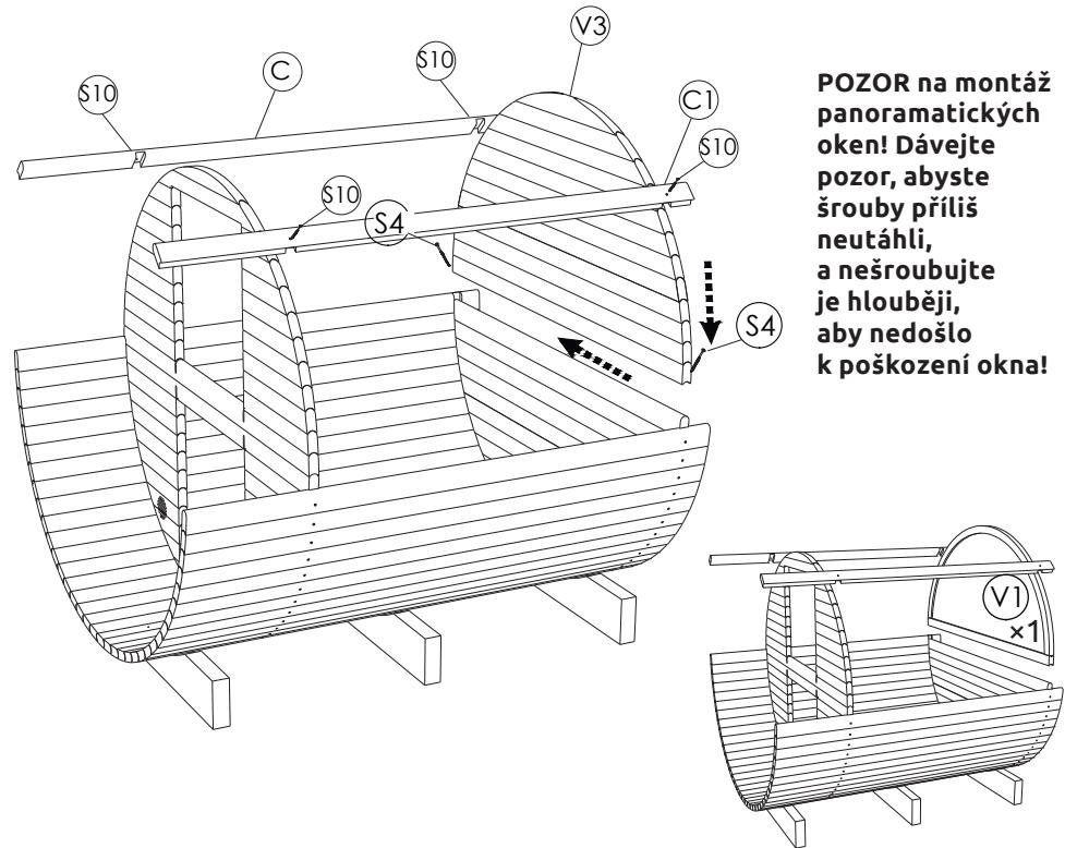
**POZOR** na montáž panoramatických oken! Dávejte pozor, abyste šrouby příliš neutáhli, a nešroubujte je hlouběji, aby nedošlo k poškození okna!
