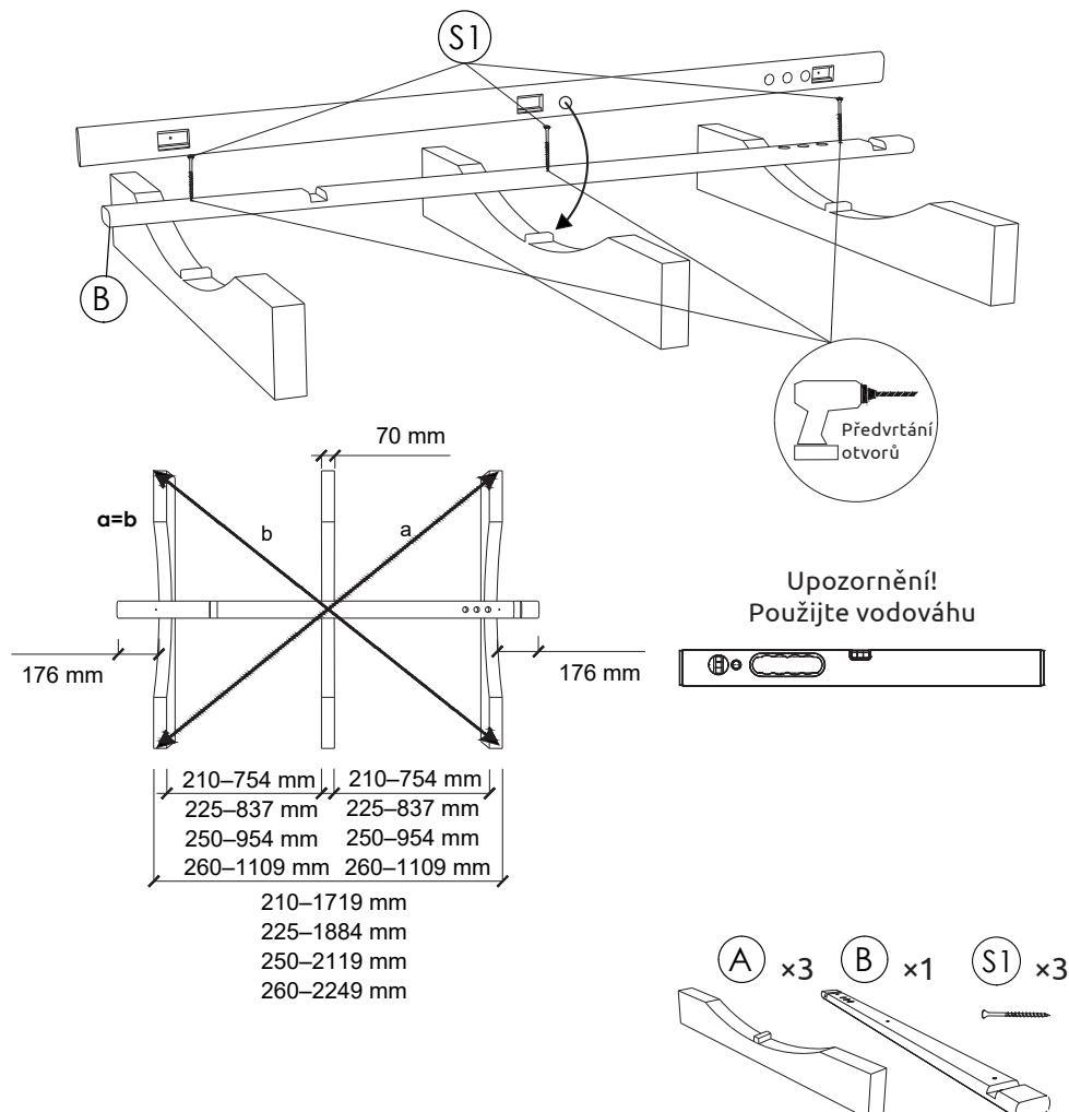
**KROK 2:** Před upevněním desek pomocí šroubů předvrťte otvory. Na každou stranu středové desky (B) umístěte 7 dílů těla sauny (C) a připevněte je pomocí šroubů 5,0 × 100 SS (S1). Ujistěte se, že je drážka panelu zarovnána na každé další tělesové patce, k tomu použijte gumové kladivo.
