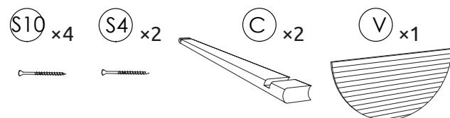
**KROK 6:** Pokračujte v pevném přikládání tělesných patek (**C**) na obě strany sauny pomocí gumové paličky a připevněte tělesné patky pomocí šroubů  $4,0 \times 60$  (**S10**). Na levé straně připevněte jednu patku výš než na pravé straně.
