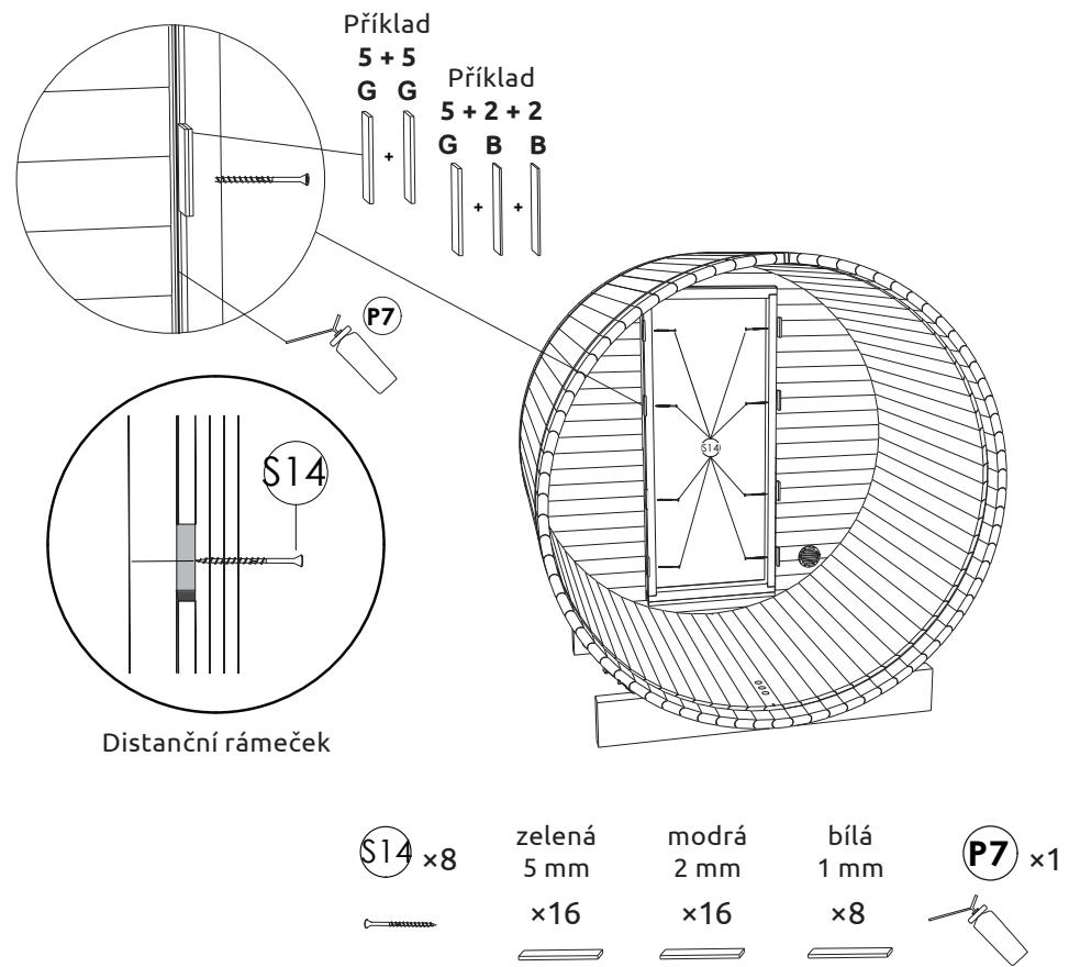
**KROK 16:** Připevněte dveřní lišty na obou stranách a na horní straně dveří pomocí šroubů (**S5**) 4 × 50 SS.
