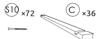
**KROK 10:** Chcete-li dokončit horní spoj střechy, nepřišroubovávejte poslední 3 desky (C) na každou stranu, použijte položku pro dokončení střechy (H). Pro úplné vyplnění mezery jsou k dispozici výplňové dílce různé tloušťky (H1). Po vložení potřebných dílů připevněte poslední prkna pomocí šroubů.
